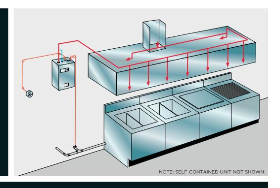
PRX™ LIQUID FIRE SUPPRESSANT ■ OVERLAPPING PROTECTION
